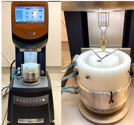
Figure 3. Rhéomètre HR20 avec la géométrie DWR (Waters | TA Instruments)
